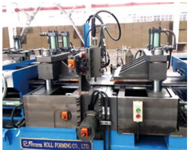
절단 & 용접 Shear & Welder
